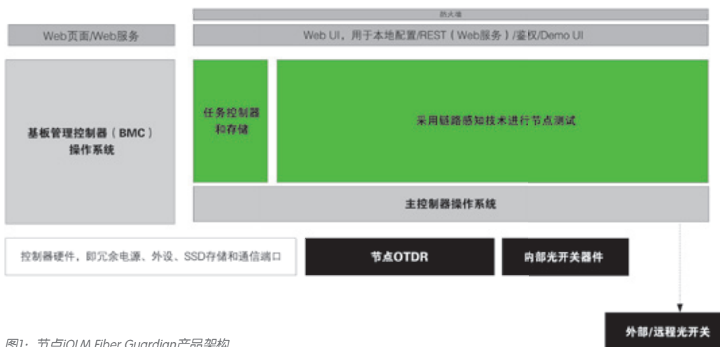
图1: 节点iOLM Fiber Guardian产品架构
